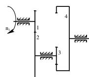
29. Определите частоту вращения  $n_3$  колеса 3 зубчатого механизма при  $n_1 = 150$  об/мин,  $z_1 = 15$ ,  $z_2 = 30$ ,  $z_3 = 75$ .
